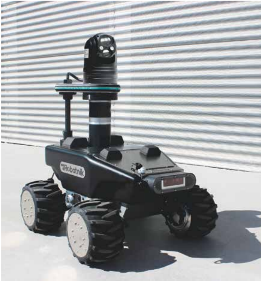
RB-WATCHER dispone de cámara bi-espectral, cámara frontal, RTK GPS y micrófono, entre otros elementos.
